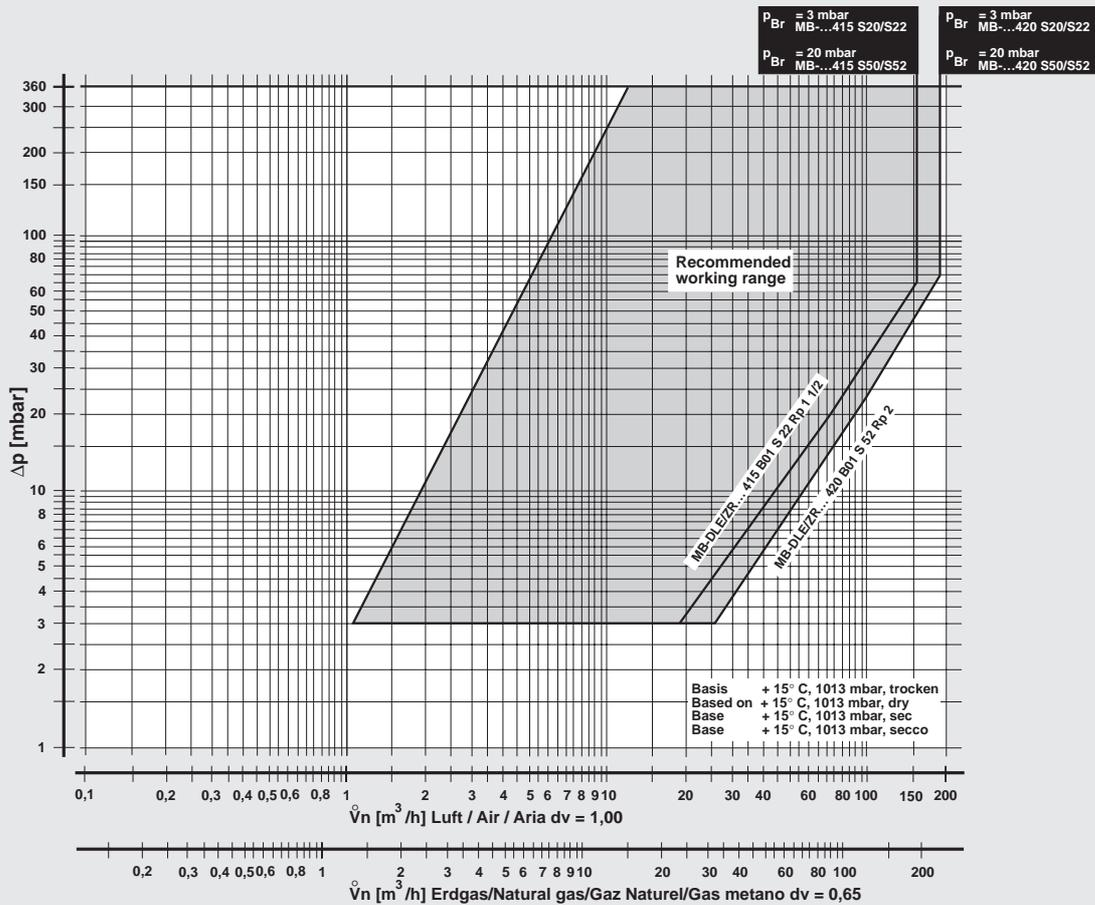
$f = \sqrt{\frac{\text{Dichte Luft}}{\text{Dichte des verwendeten Gases}}}$
