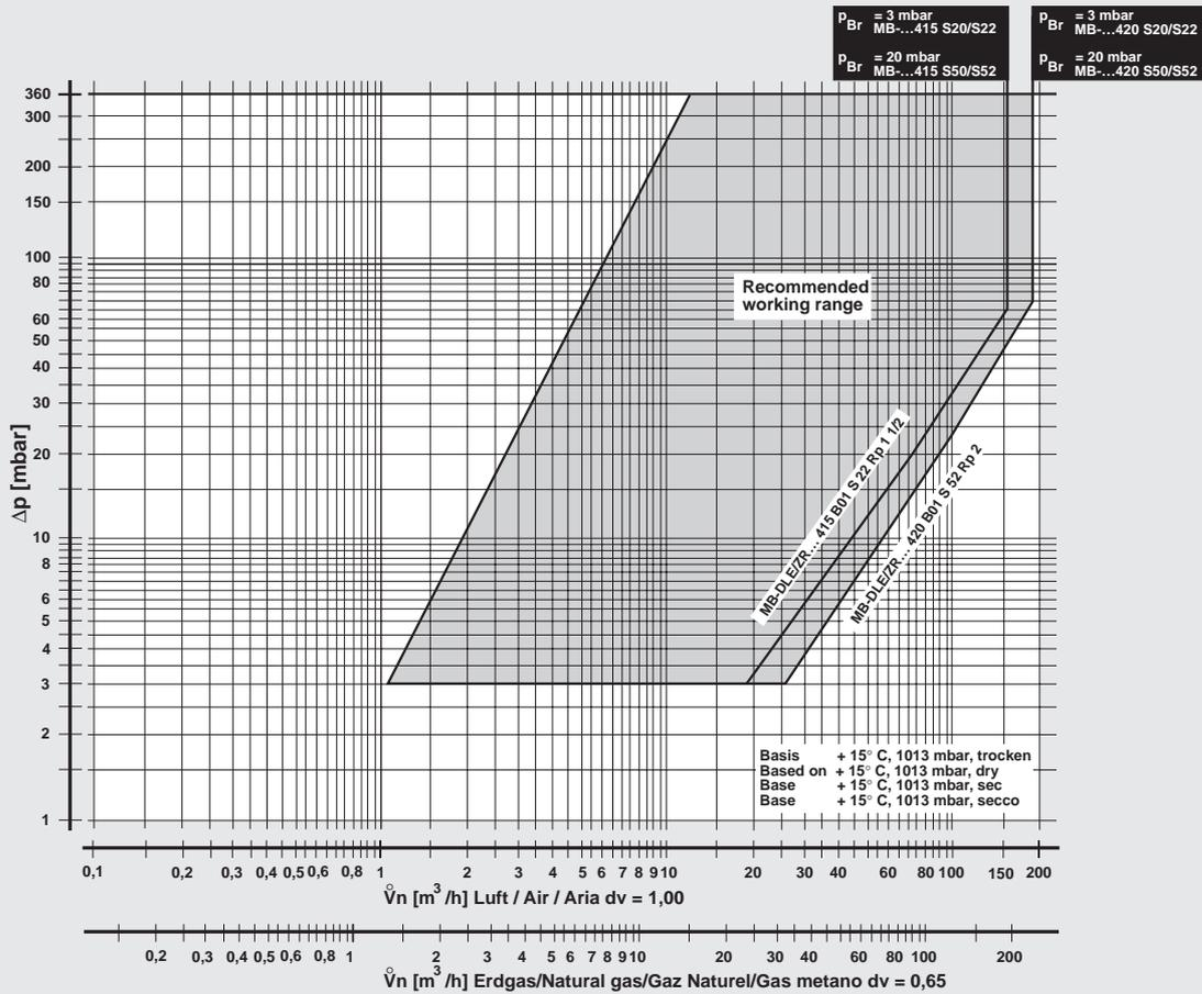
$$f = \sqrt{\frac{\text{Dichte Luft}}{\text{Dichte des verwendeten Gases}}}$$
